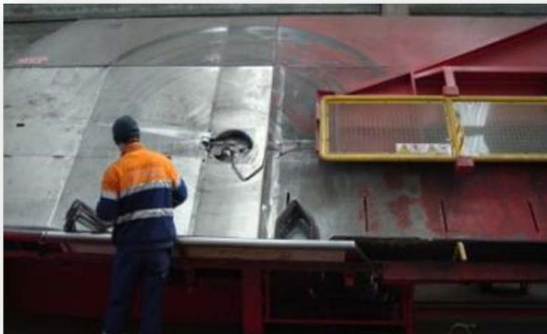
O corte e dobragem das armaduras são feitos de forma industrial, a partir de máquinas concebidas para o efeito. A montagem das mesmas é efetuada garantindo-se os recobrimentos definidos em projeto e a validação de todos os parâmetros do controle de qualidade.
